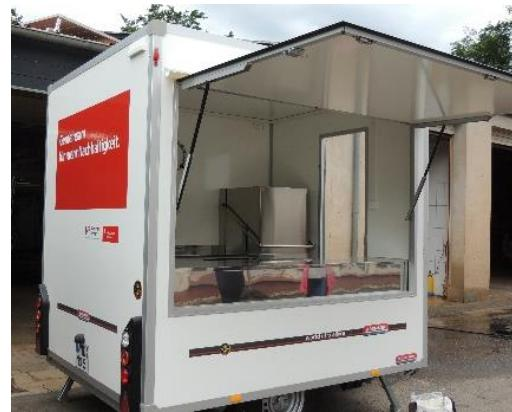
Das Spülmobil ist wie auf dem Foto zu sehen, ein begehbarer PKW-Anhänger, der mit einer Gewerbespülmaschine (Durchschubspülmaschine) und einem Edelstahl-Arbeitstisch mit Spülbecken ausgestattet ist.
